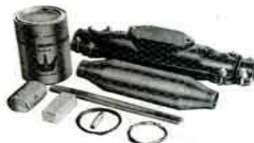
Сл. 37. Права оклопна спојница са унутрашњом оловном, за радни напон до 1 kV: 1 – цртеж спојнице у две пројекције; 2 – спојница са прибором за монтажу (везна жица, уље за уземљење), изолациона трава, импрегнирани папир, азбестна трака, јутана трака, паста за лемљење, стерион и маса за ваљање, унутрашње и спољне заштитне спојнице
